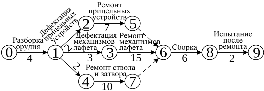
Рис. 2.8 Сетевой график в терминах работ и событий
