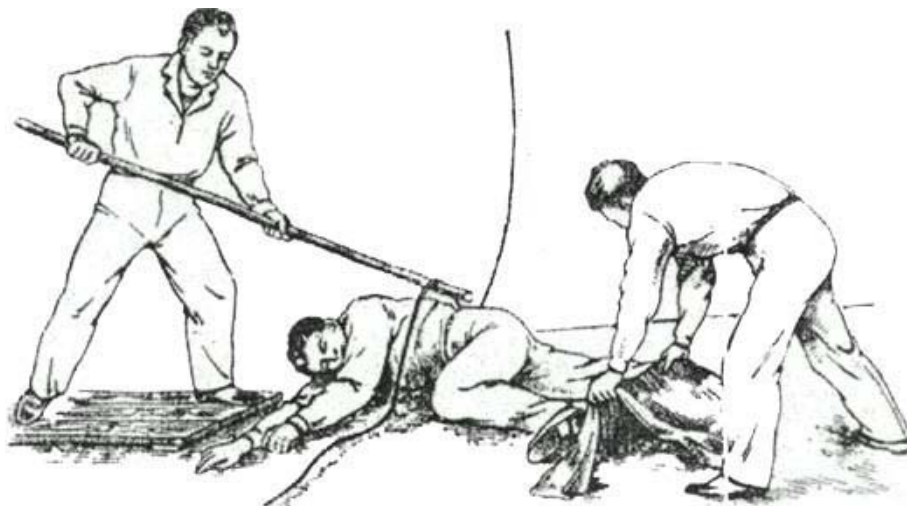
Рис. 1. Освобождение пострадавшего от действия электрического тока
